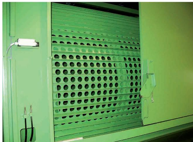
**Individualität in höchstem Maße:** Die AVERMANN Siebtrommel ist in verschiedenen Sieblängen, Durchmessern und Lochungen erhältlich und wird exakt an Ihre Anforderungen angepasst. Ein Nachrüsten ist jederzeit möglich, so dass die Anlage auch im Nachhinein auf
