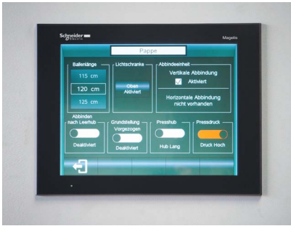
Touchscreen-Display zum Einstellen für individuelle Materialparameter
