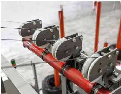
Drahttriss- und Drahtendeüberwachung zur Kontrolle der Bindedrähte
