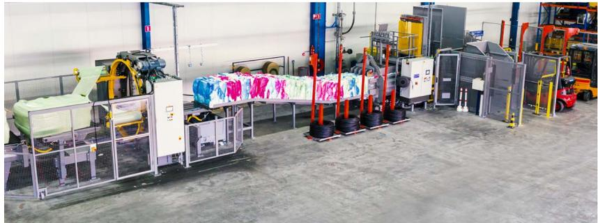
Vollautomatische Press- und Wickelanlage
