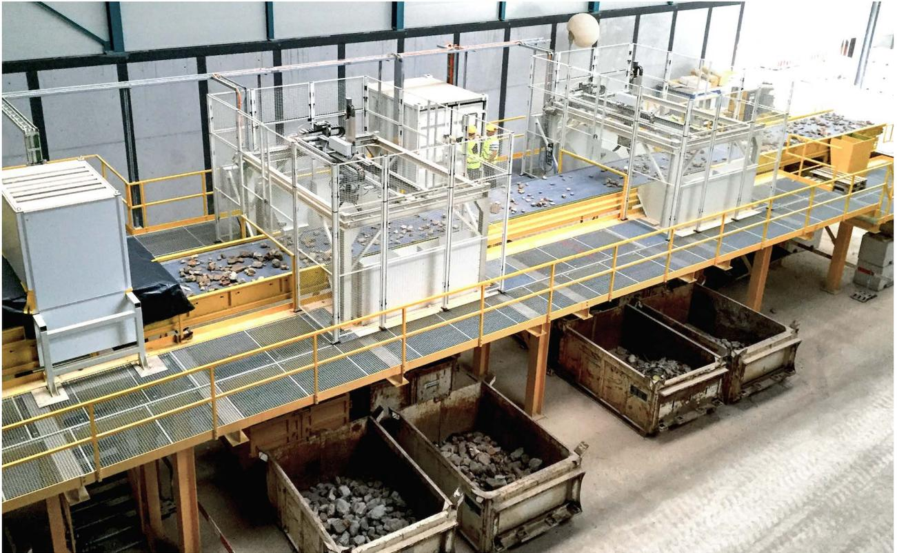
Sortierband für vollautomatische Robotersortierung
