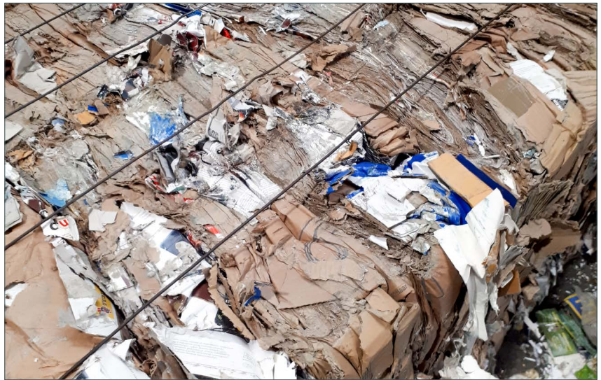
Schnittfläche mit OptiCut bei Ballenmaterial 1.04
