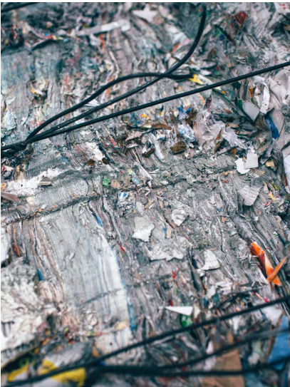
Schnittfläche mit OptiCut bei Ballenmaterial 1.02
