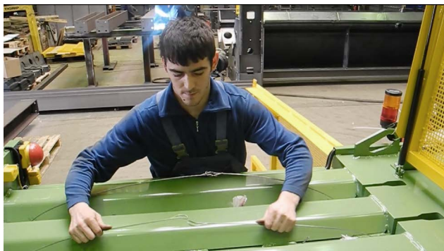
Ligature manuelle avec liens préfabriqués à attache rapide
