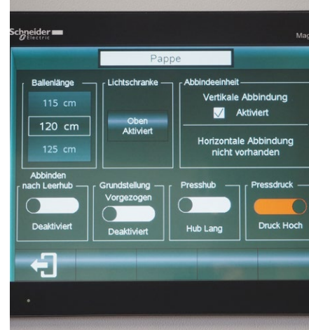
Touchscreen-Display zum Einstellen für individuelle Materialparameter
