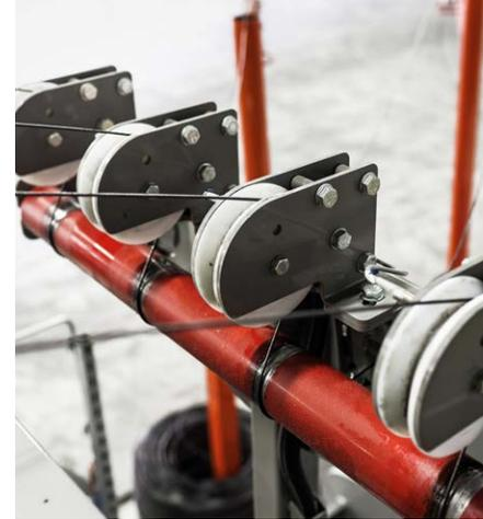
*Drahriss- und Drahtendeüberwachung zur Kontrolle der Bindedrähte*
