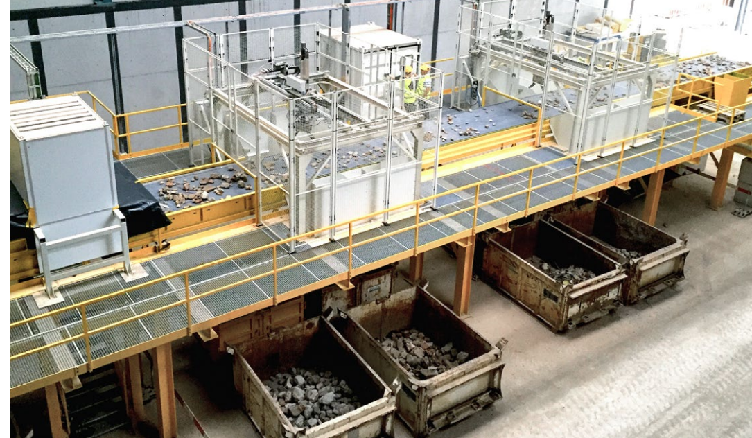
Sortierband für vollautomatische Robotersortierung
