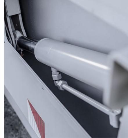
Außen liegender Hydraulikzylinder
