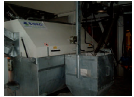
Recyclinganlage Typ ComTec mit Pumpensumpf
