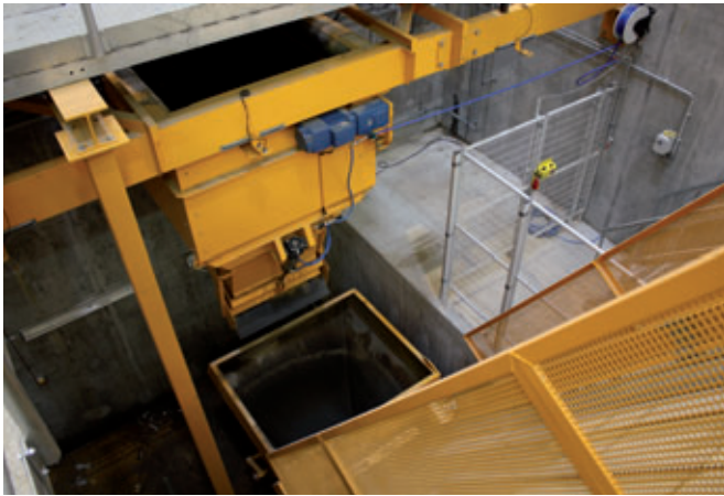
Übergabe der Zuschlagstoffe an die drei Schrägkübelaufzüge
