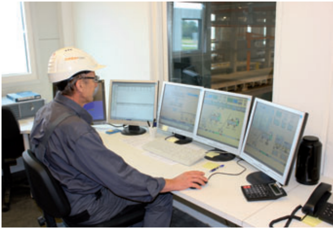
Die Skakomat 600 Steuerung organisiert sämtliche Mischprozesse
