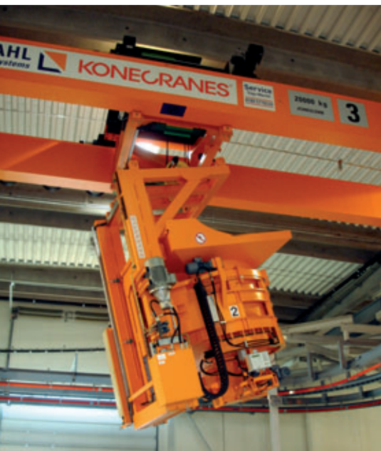
Betonverteiler beim Ankoppeln an den Kran
