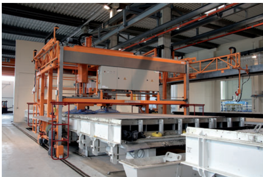
Funkgesteuerter Flügelglätter mit 2 Glätteinheiten
