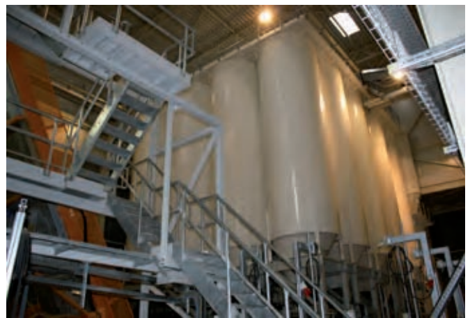
Distribución de los áridos en los 24 silos.
