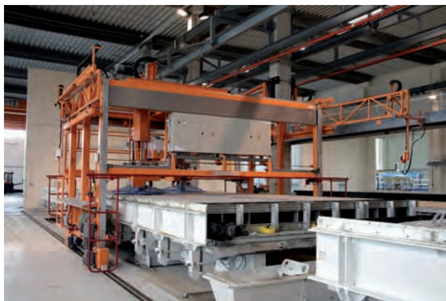
Alisadora de control remoto con dos unidades de alisado.
