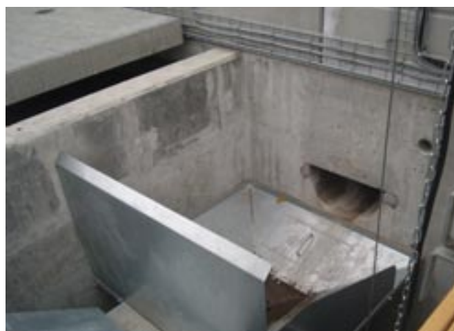
Obszar przekazywania materiału z rynny do systemu recyklingu typu RWS.
