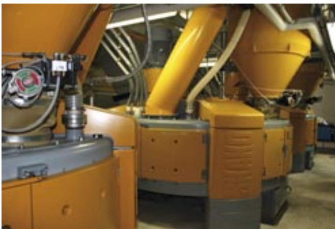
Firma Ambercon wykorzystuje trzy betoniarki Apollo.
