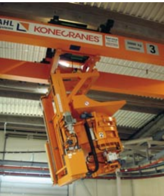
Podajnik betonu podczas przyłączania do suwnicy.
