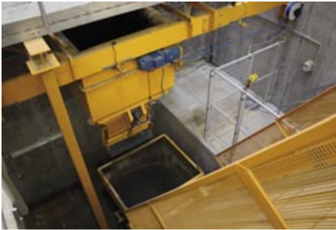
Przekazywanie kruszywa na trzy wyciągi pochyłe ze skipami.
