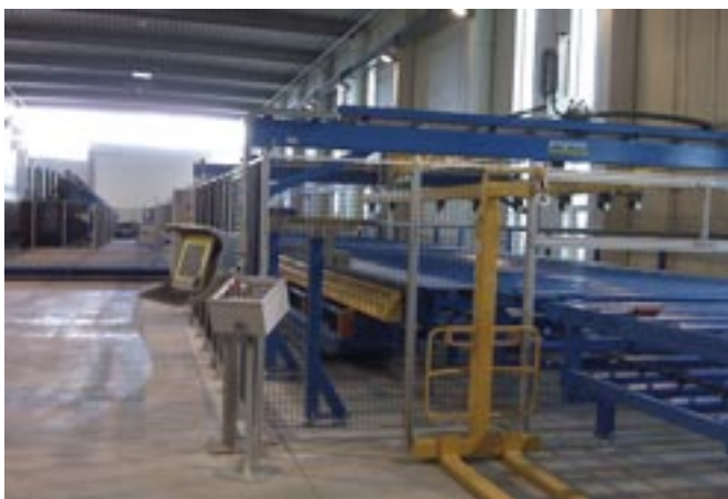
Automat do spawania siatek umożliwia produkcję siatek o wymiarach do 6 m x 12 m.
