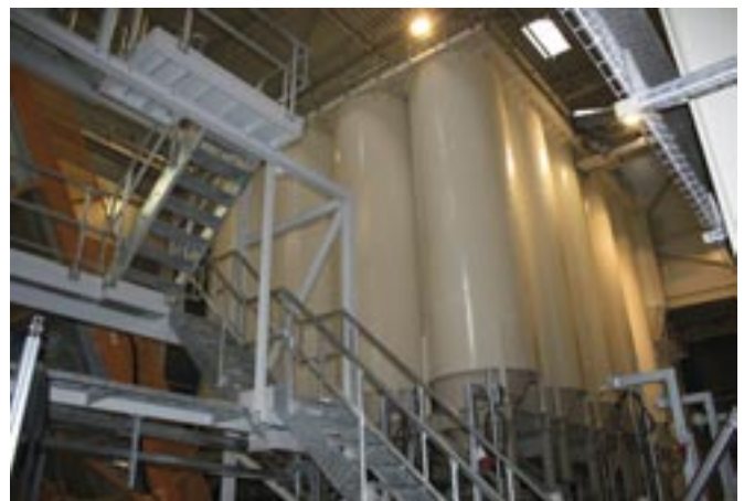
Rozdzielanie kruszywa na 24 silosy.
