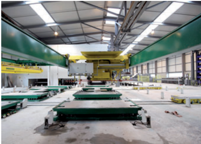
Schwingverdichter und Betonierstation mit Betonverteiler
