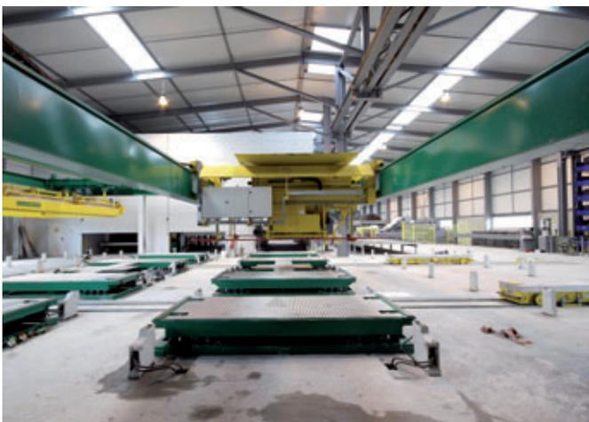
Compacteur à vibrations et station de coulage avec distributeur de béton
