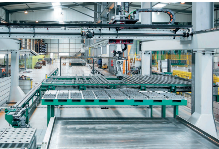
Robot de encofrado y almacén de encofrados
