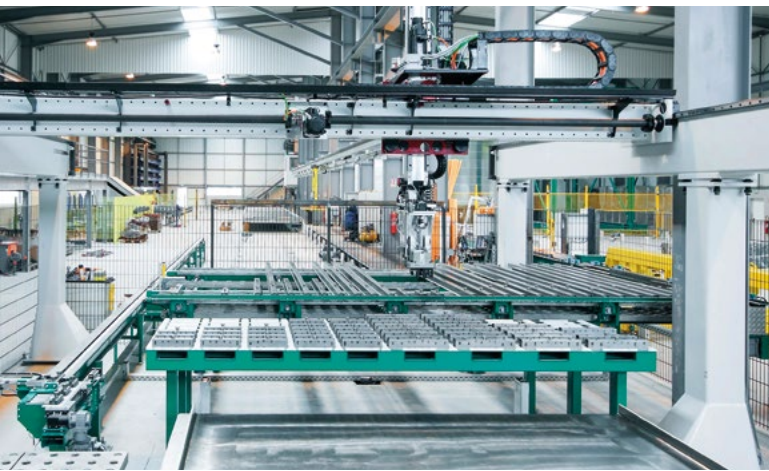
Robot de coffrage et magasin
