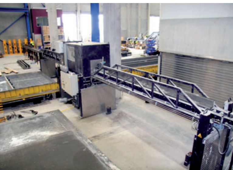
Abschalerreinigung mit Transporteinrichtung
