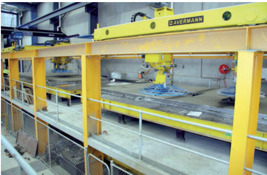
Glättstation mit Flügelglätteinrichtungen
