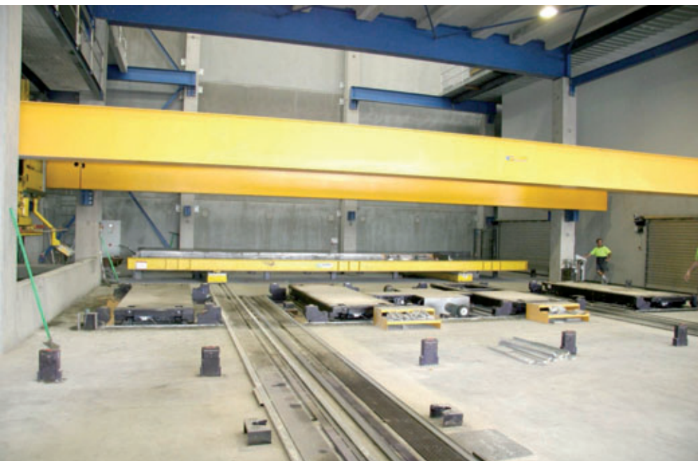
Le déplacement transversal sous le distributeur de béton et le compacteur vibrant
