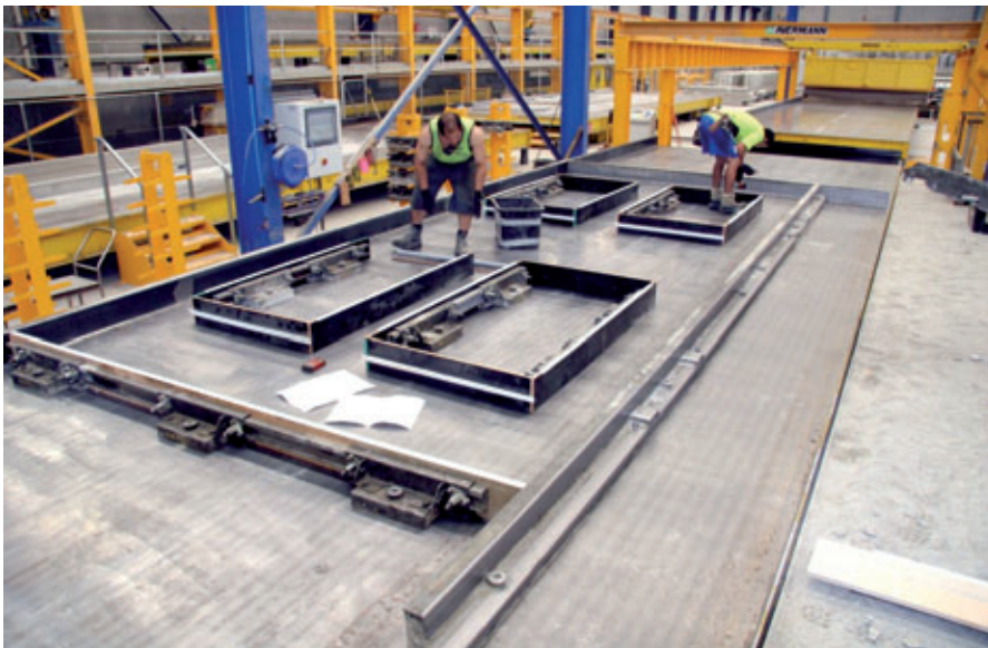
Le poste de coffrage manuel
