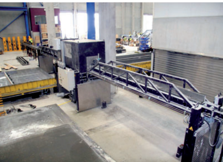
Le nettoyage des éléments de coffrage avec dispositif de transport
