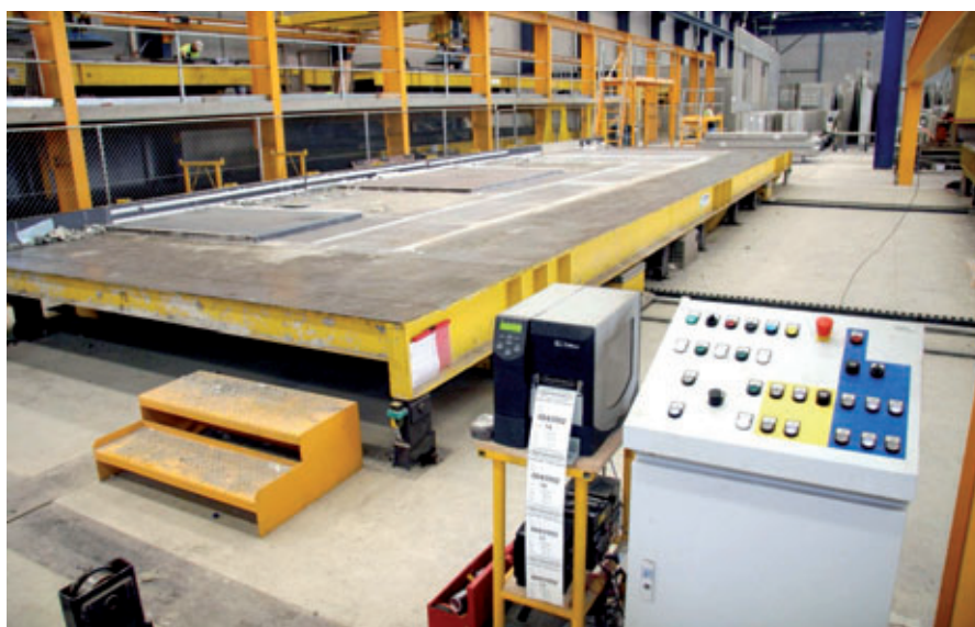
La station de basculement avec panneau de commande et imprimante à étiquettes
