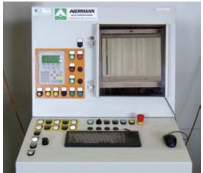
Pulpit sterowania urządzenia obsługującego regały.
