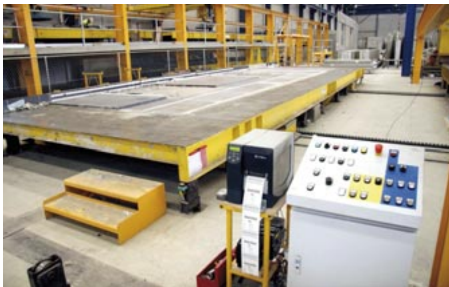
Stanowisko uchylnie z pulpitem operatora i drukarką etykiet.
