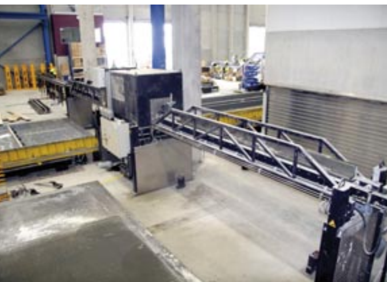
Stanowisko czyszczenia z przenośnikiem odtransportowującym elementy szalunku.
