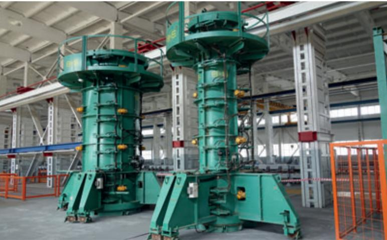
Moldes para la fabricación de tubos de hormigón
