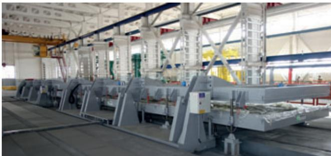
Bandejas abatibles para la fabricación de muros dobles y prelosas armadas
