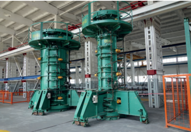
Moules destinés à la fabrication de tuyaux en béton
