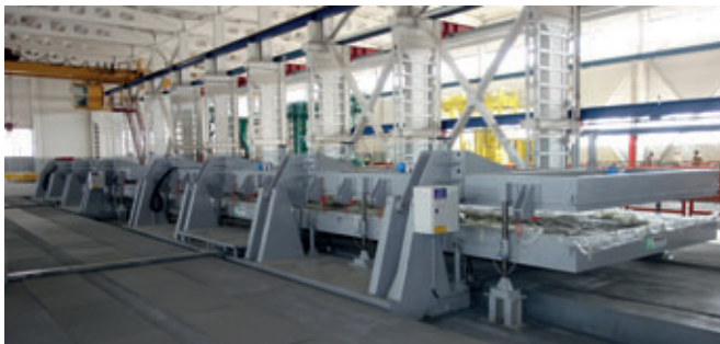
Palettes rabattables permettant la fabrication de doubles parois et de prédalles
