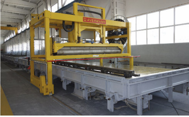
Widok na jedną z dwóch hal produkcyjnych ze stołami uchylnymi i wygładzarką.
