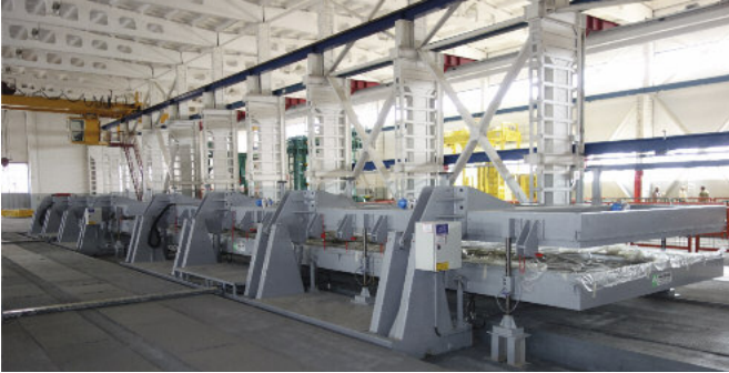
Składane podkłady do produkcji ścian warstwowych i płyt stropowych typu filigran.
