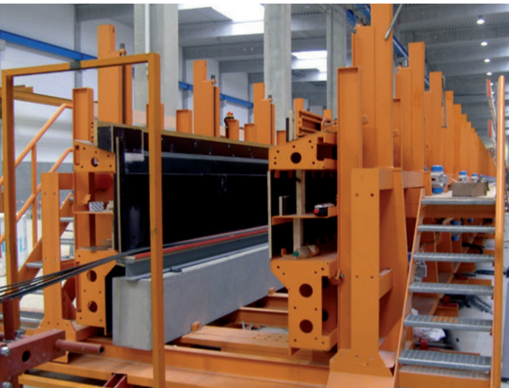
Coffrage avec pièces d'accrochage pour poutre à treillis
