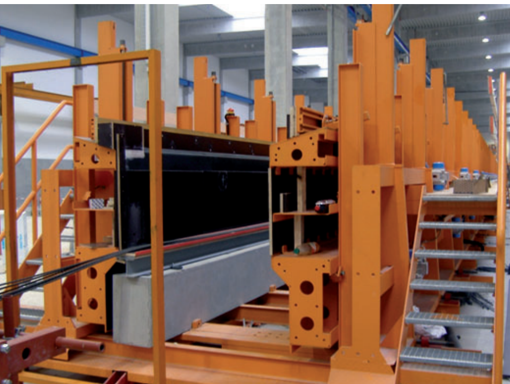
Schalung mit Einhängeteilen für Binder
