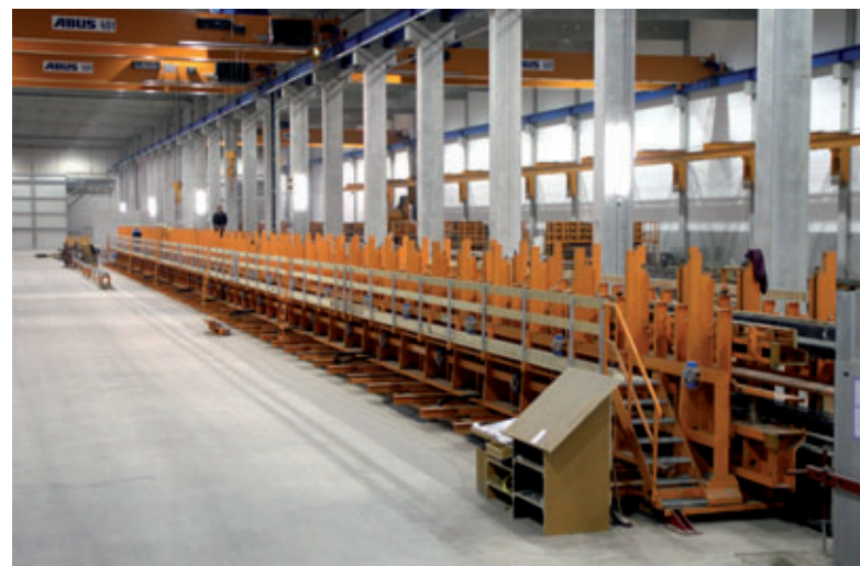
Gesamtansicht der 99 m langen Universalschalung
