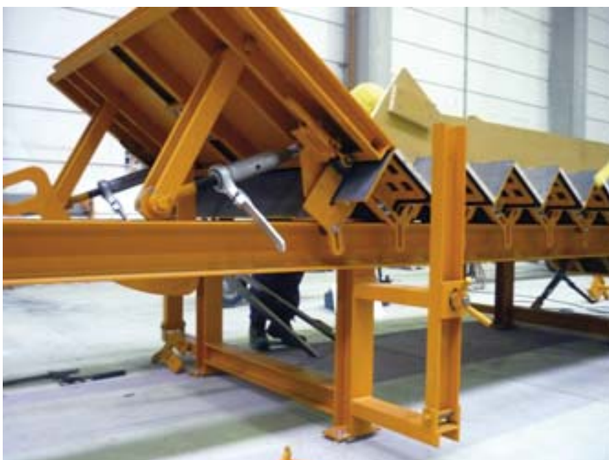
5: Widok szczegółowy – regulacja nachylenia spocznika górnego.
