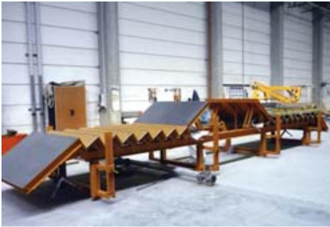
3: Opcjonalne wykorzystanie szalunku do jednoczesnej produkcji 2 biegów schodowych
