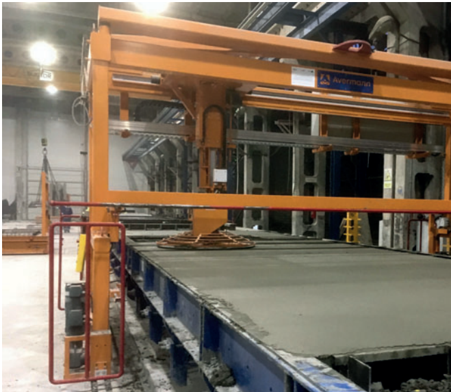
Flügelglätter beim Glättvorgang
