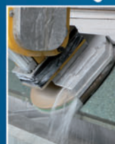
Schleifen von geraden und geneigten Kanten
