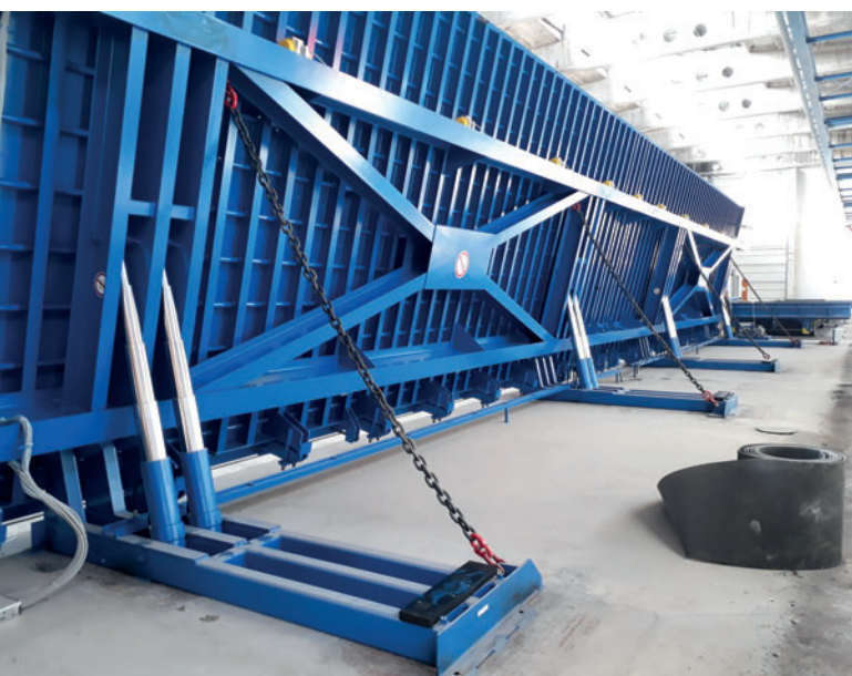
Kipptischlinie zur Produktion von Wänden
