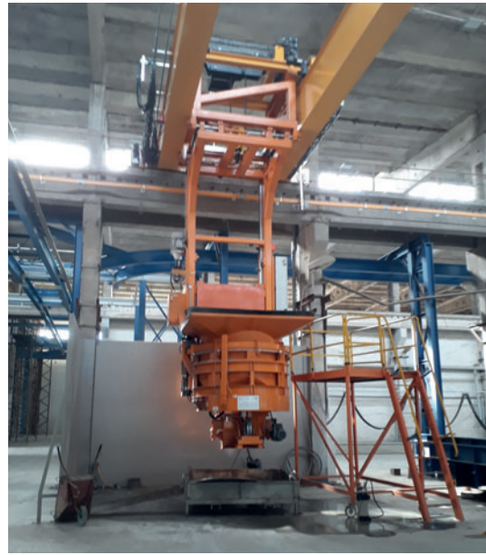
Betonverteiler beim Ankoppeln an den Kran
