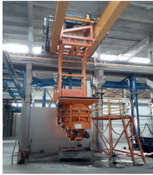
Le distributeur de béton au moment du couplage avec le pont roulant
