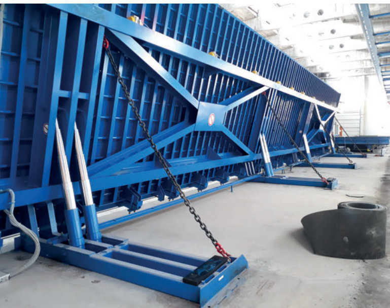
Línea de mesas de volteo para la producción de muros
