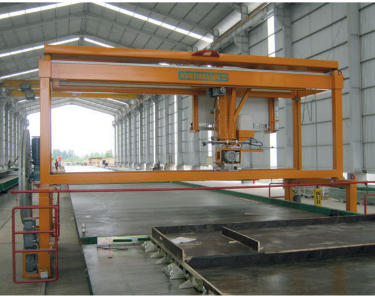
Zur Kipptischfertigung gehört dieser Flügelglätter, der den Rückseiten der flächigen Betonfertigteile die gewünschte hohe Qualität gibt.
