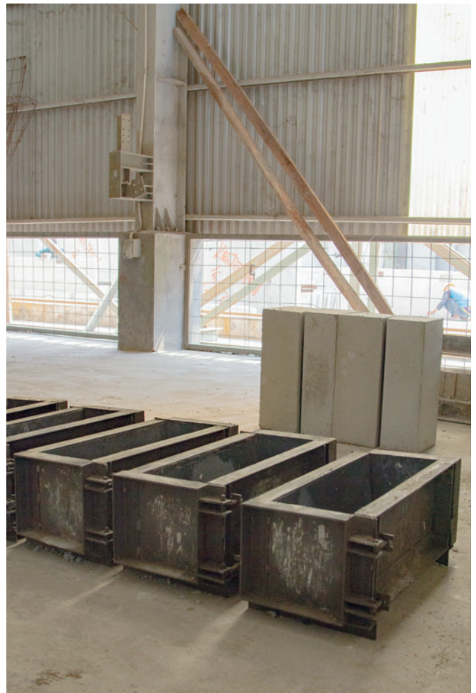
Restbeton verwendet PT Motive Mulia für ein Nebenprodukt, nämlich Bordsteine, die u. a. in der Hauptstadt Jakarta Bürgersteige vom Fahrbahnbereich trennen (hinten). Die Stahlformen dafür (vorne) baut die Firma selbst.
