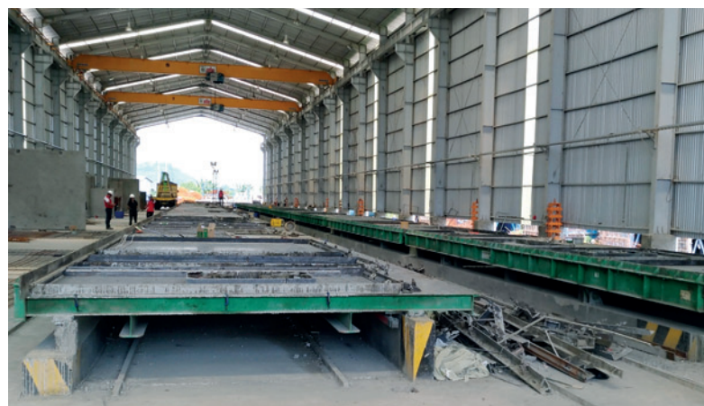
W hali produkcyjnej znajduje się 16 stołów uchylnych ustawionych w dwóch równoległych liniach.
