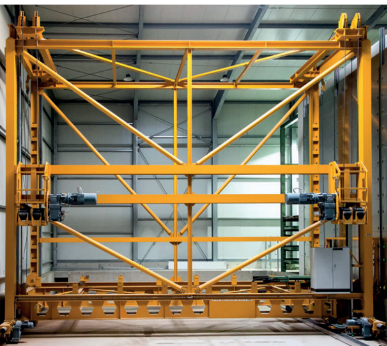
Regalbediengerät für die Beschickung der Härtekammer
