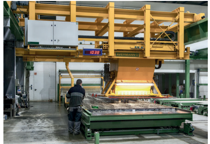
Distributeur de béton en version portique
