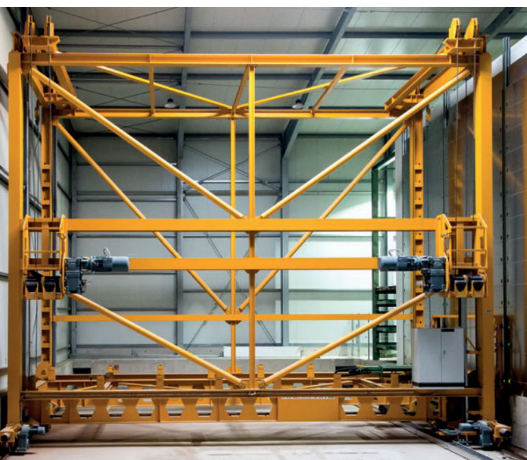
Transstockeur pour l'approvisionnement des chambres de durcissement
