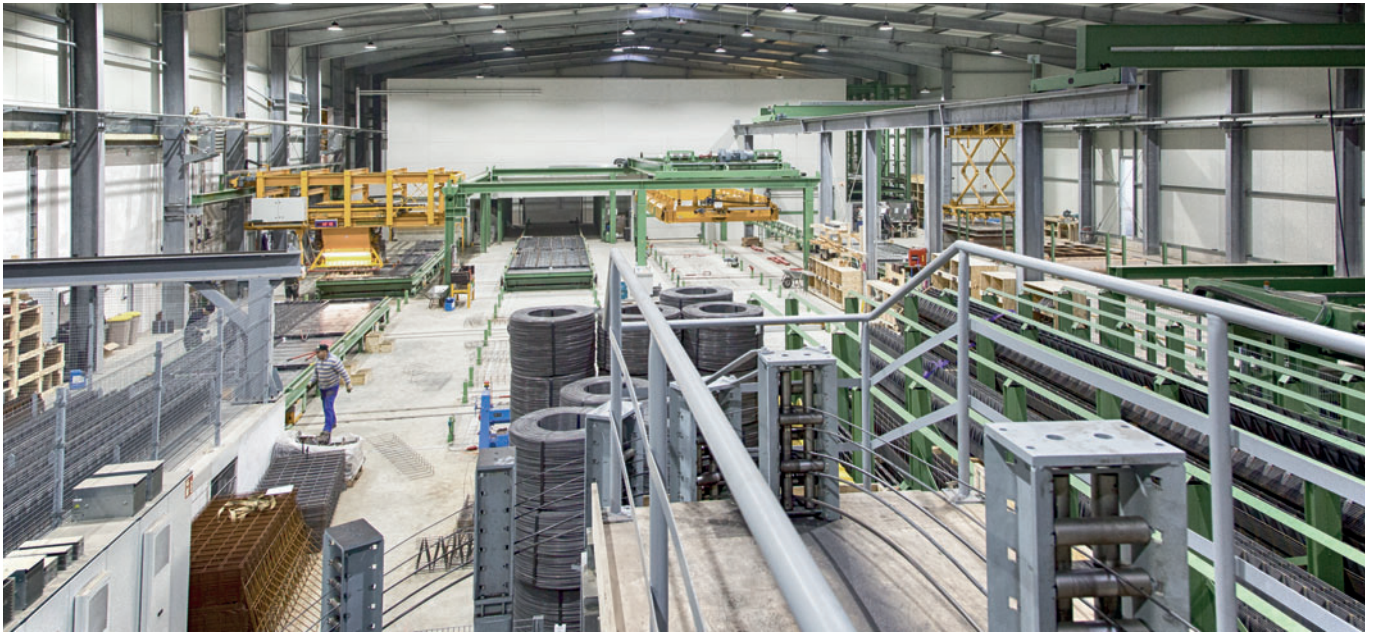
Circuit de palettes dans le secteur Bétonnage / compactage, retournement et station de levage
