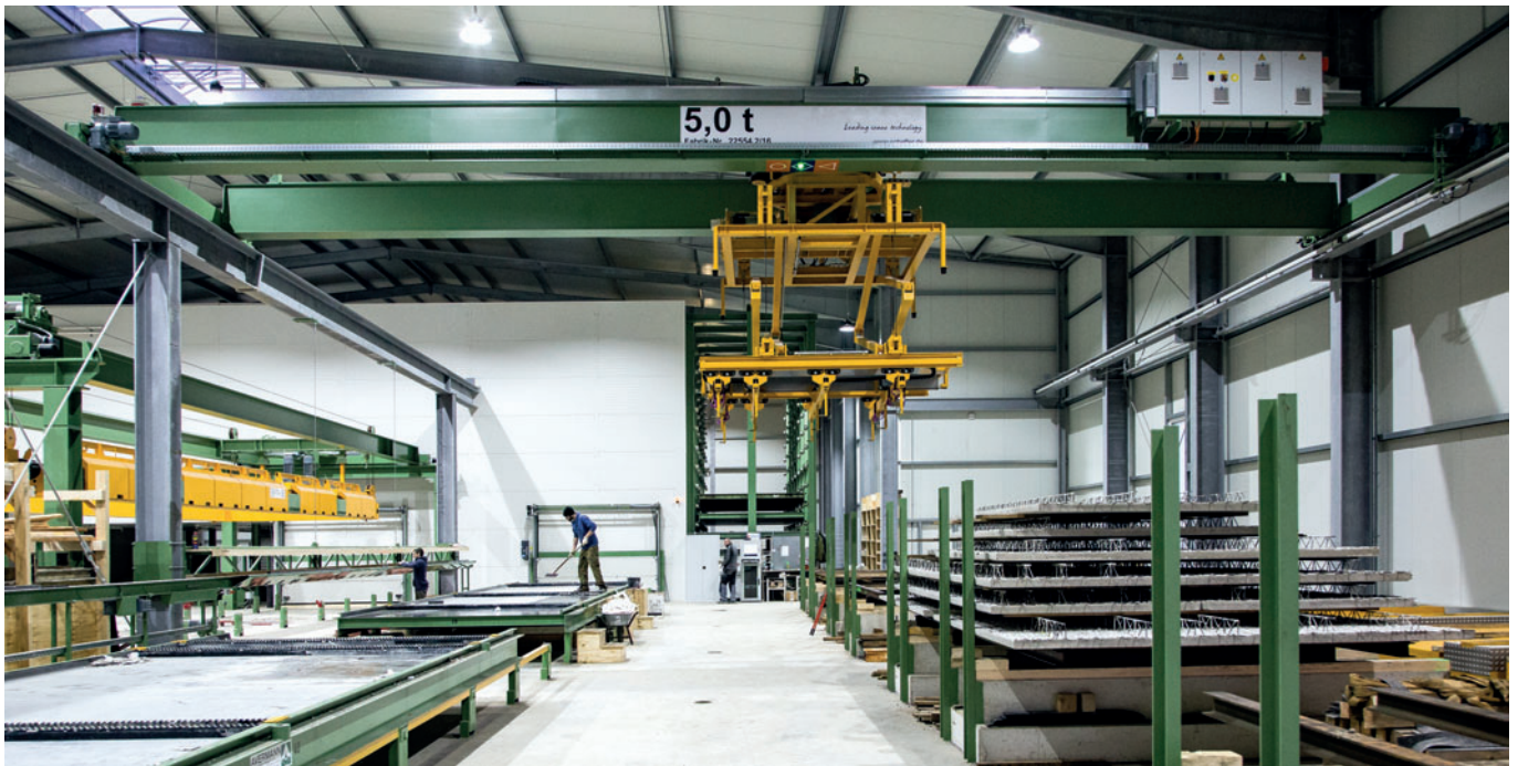
Grue spéciale permettant de soulever les dalles de plancher
