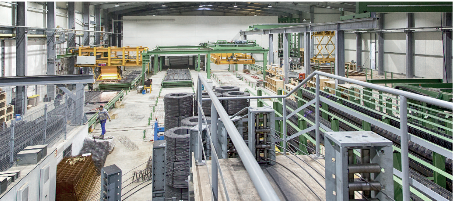
Obszar betonowania / zagęszczania, odwracania i podnoszenia elementów.
