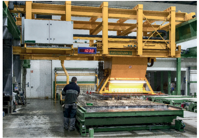
Rozścielacz mieszanki betonowej w wersji bramowej.
