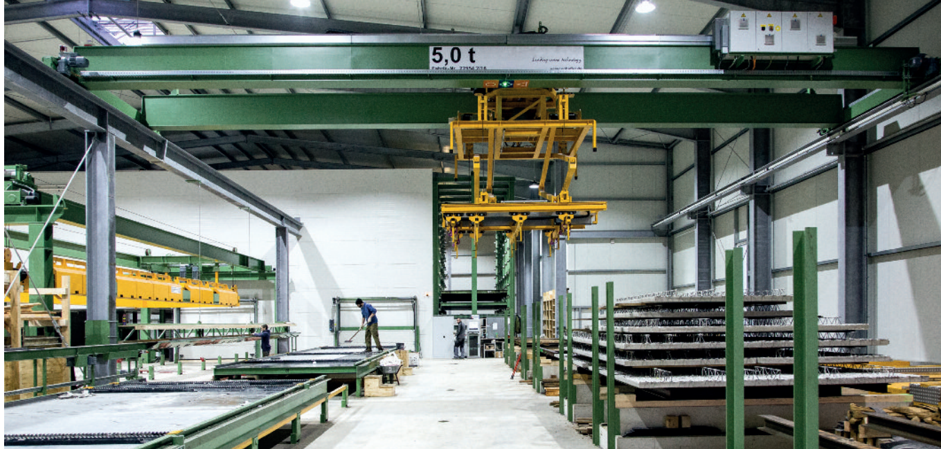
Specjalna suwnica do zdejmowania płyt stropowych.
