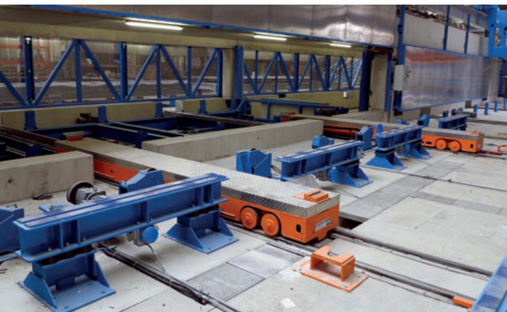
Fig. 4: Plataforma central de desplazamiento con carro de elevación transversal entrando en la estación de compactación
