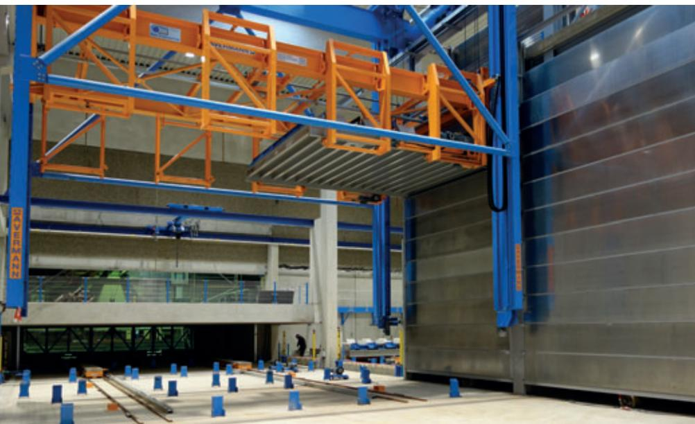
Fig. 3: Transelevador para la alimentación de la cámara de curado
