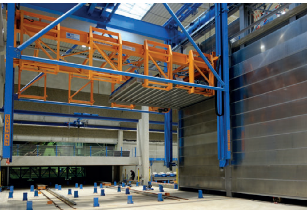
Transtockeur pour le chargement des chambres de durcissement
