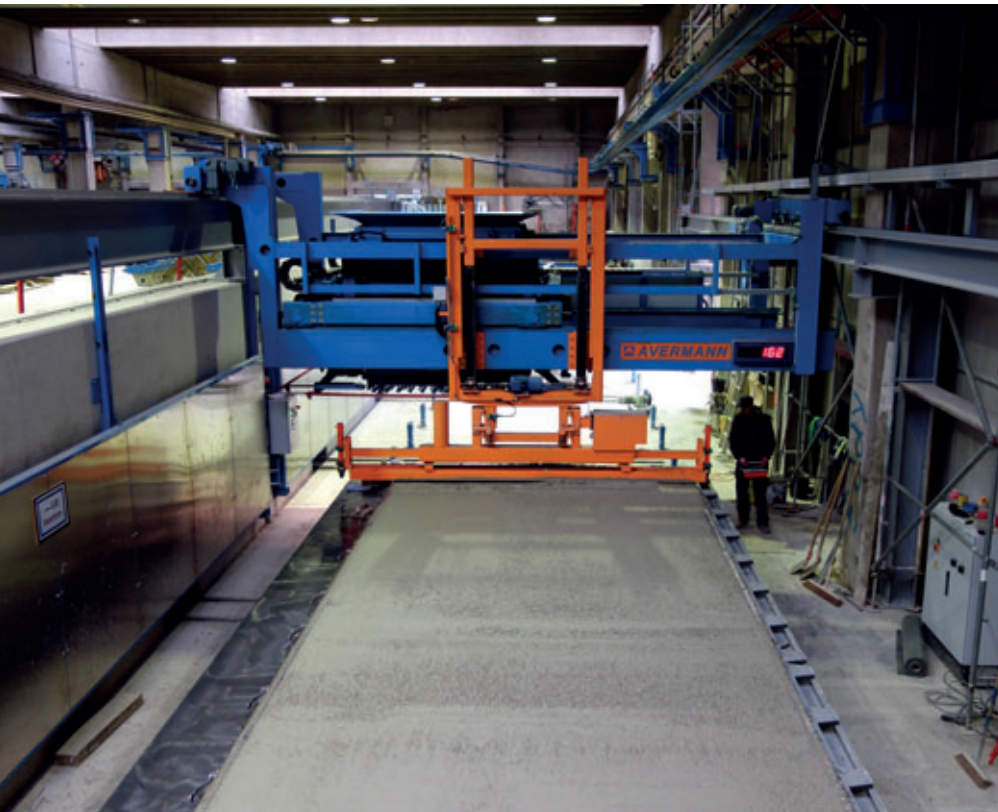
Distributeur de béton en version portique avec dispositif de raclage
