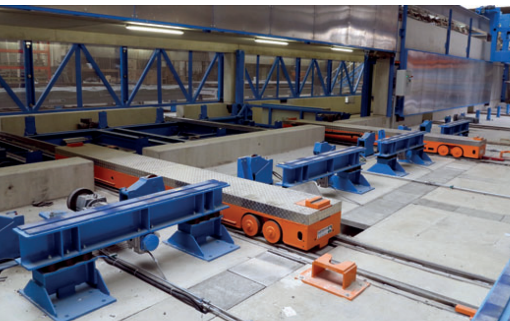
Plateforme de déplacement centrale avec chariot de déplacement transversal lors de l'accès à la station de compactage
