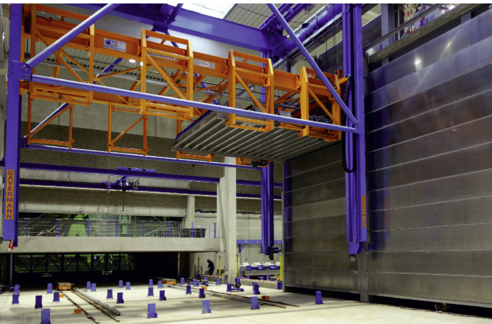
Urządzenie obsługujące regały komór dojrzewania.
