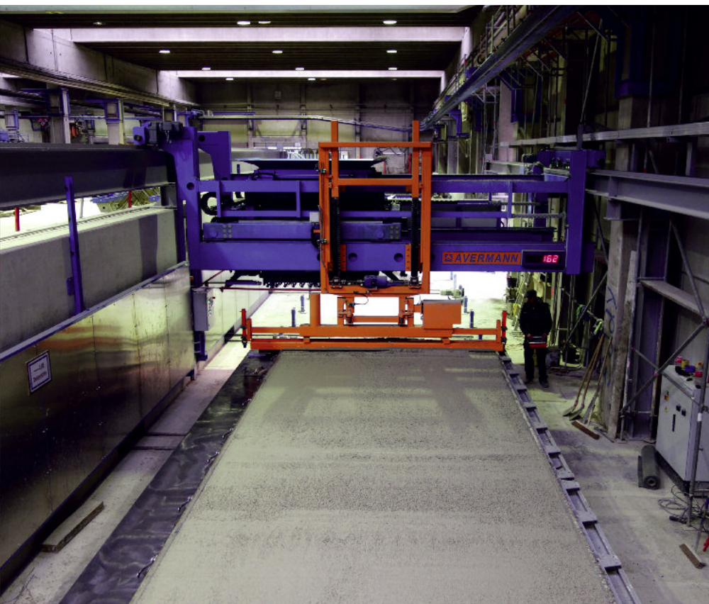
Rozścielacz mieszanki betonowej zamontowany na suwnicy bramowej wraz z urządzeniem wygładzającym.
