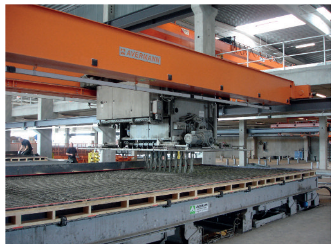
5. Stanowisko betonowania z rozścielaczem mieszanki betonowej i systemem zagęszczania wibracyjnego firmy Avermann.
