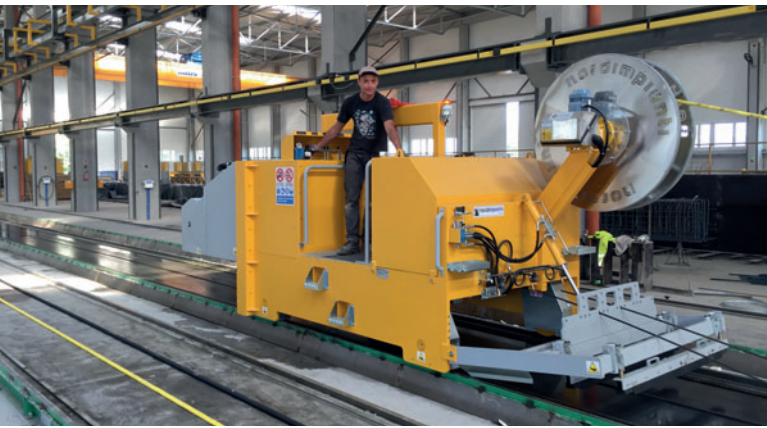
Multifunktionaler Bettreiniger bei der Vorbereitung des Spannbetts
