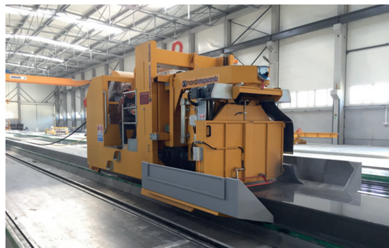
Mehrwinkelsäge beim Schneiden von 500 mm starken Spannbetonfertigdecken
