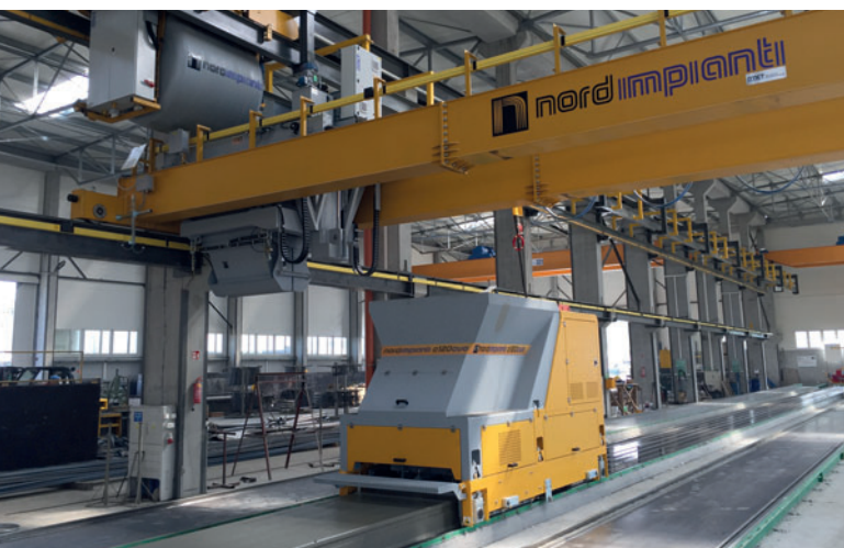
EVO-Extruder mit vollautomatischem Betonverteilsystem
