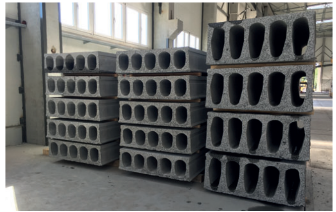
Hochwertige Spannbetonfertigdecke, hergestellt mit dem EVO Extruder von Nordimpianti
