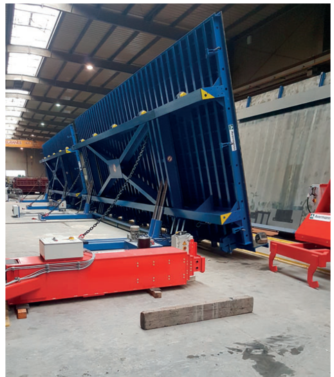
Acht qualitativ hochwertige hydraulische Kipptische mit einer Größe von je 13 x 4,5 m wurden bei Zbych-Pol & Mobet Sp. z o.o. installiert.
