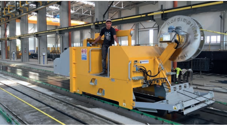
Limpiadora de pistas multifunción durante la preparación de la pista de pretensado
