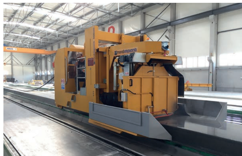
Sierra multiangular cortando placas alveolares pretensadas de 500 mm de espesor
