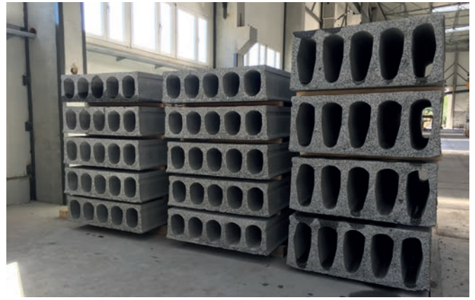
Placa alveolar pretensada de alta calidad, fabricada con la extrusora EVO de Nordimpianti
