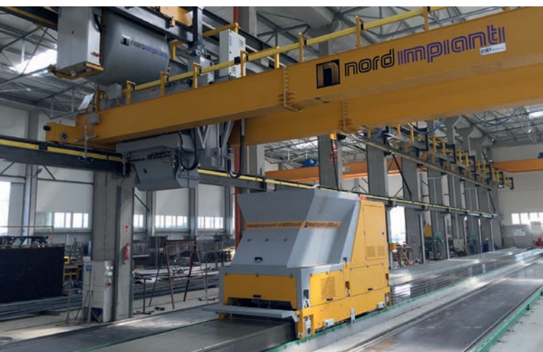
Extrusora EVO con sistema automático de distribución de hormigón
