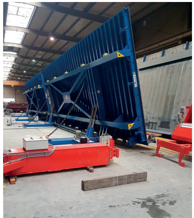
W zakładzie firmy Zbych-Pol & Mobet Sp. z o. o. zamontowano osiem wysokiej jakości hydraulicznych stołów uchylnych o wymiarach 13 x 4,5 m.
