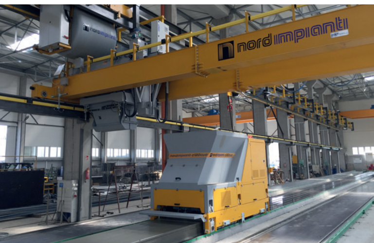
Ekstruder EVO z całkowicie automatycznym systemem dystrybucji mieszanki betonowej.
