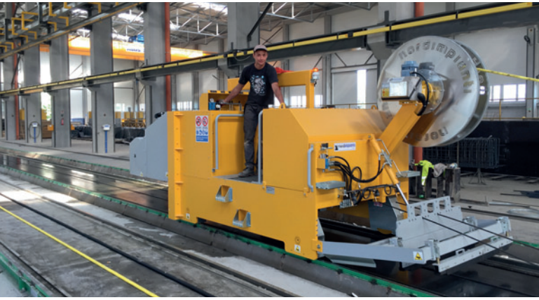
Wielofunkcyjna maszyna do czyszczenia i przygotowywania torów produkcyjnych.
