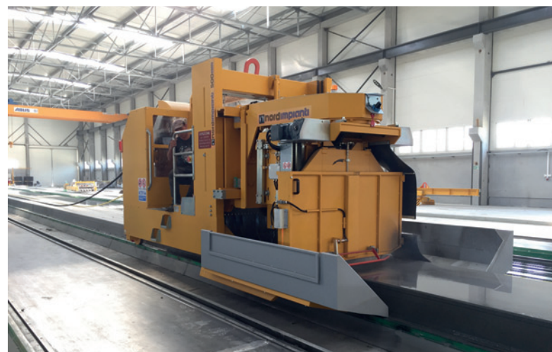
Piła do cięcia pod różnymi kątami płyt kanałowych o grubości 500 mm.
